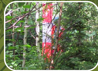
Plaque à profil permettant la mesure de l'obstruction latérale
